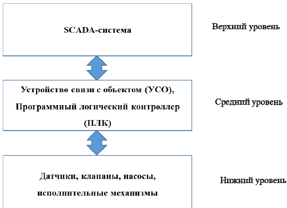
Рис. 4. Уровни системы промышленной автоматизации
