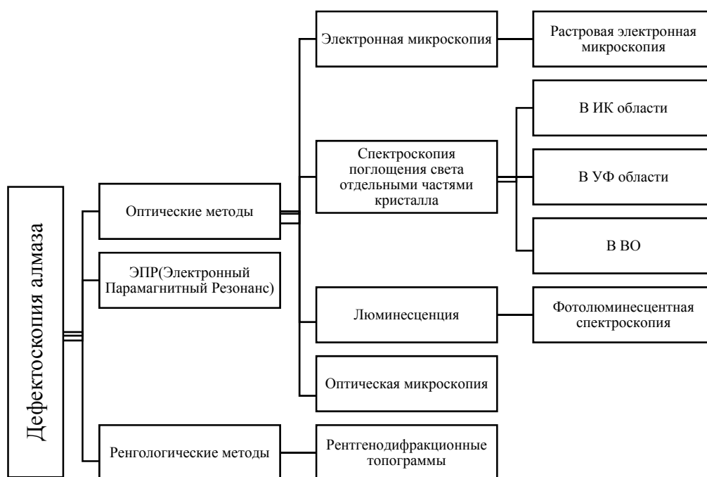
Рис. 2. Методы по обнаружению дефектов в кристаллах драгоценных камней [4]
