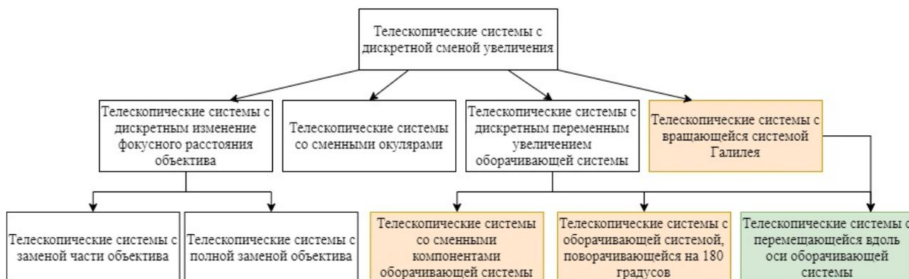
Рис. 6. Классификация телескопических систем с дискретной сменой увеличения
