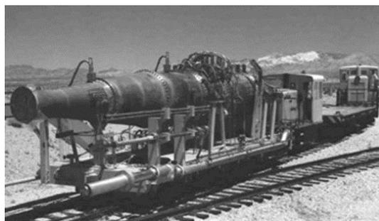
Рис. 3. Прототип двигателя в рамках проекта «Pluto»
