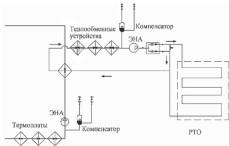
Рис. 4. Структурная схема газожидкостной системы терморегулирования
