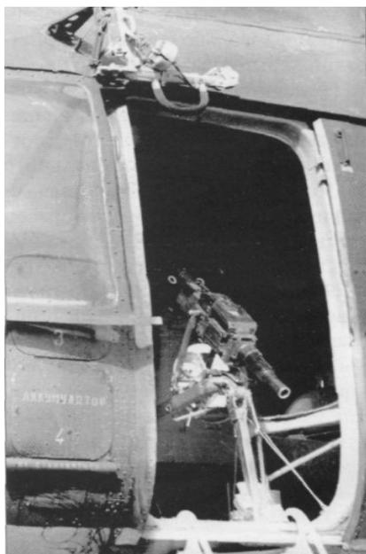
Рис. 3. Установка АГС-17 в проеме вертолета Ми-8Т
