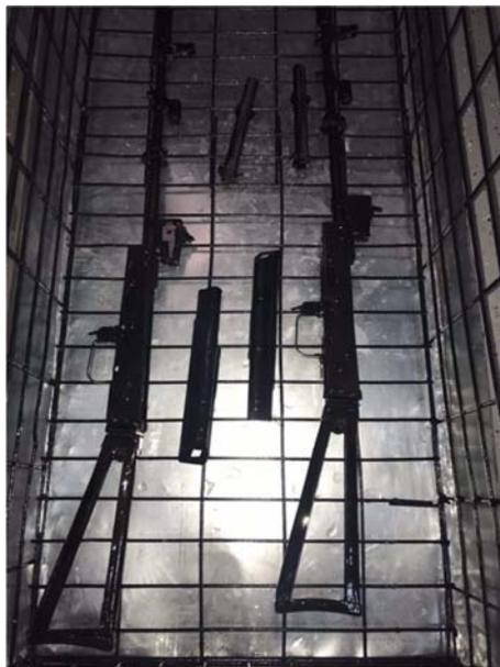
Рис. 3. Химическое обезжиривание деталей.
