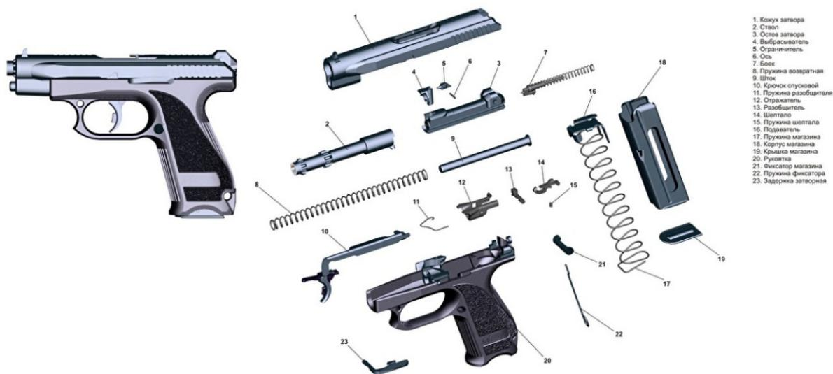
Рис. 1. Общее устройство пистолета
