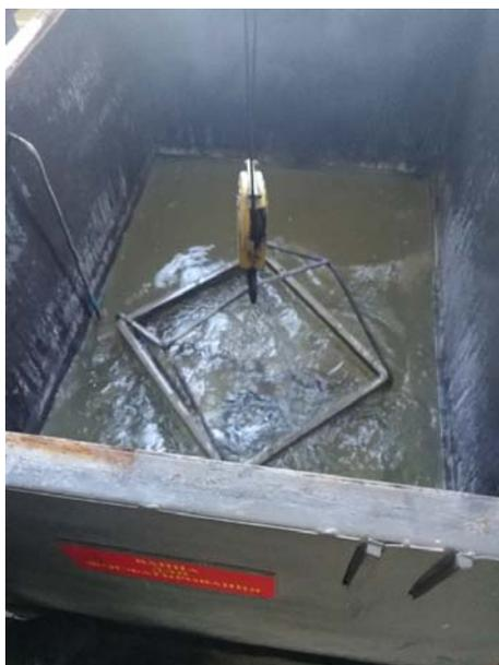
Рис. 2. Процесс фосфатирования
