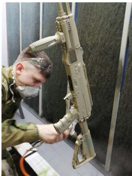
Рис. 1. Нанесение защитного покрытия.
