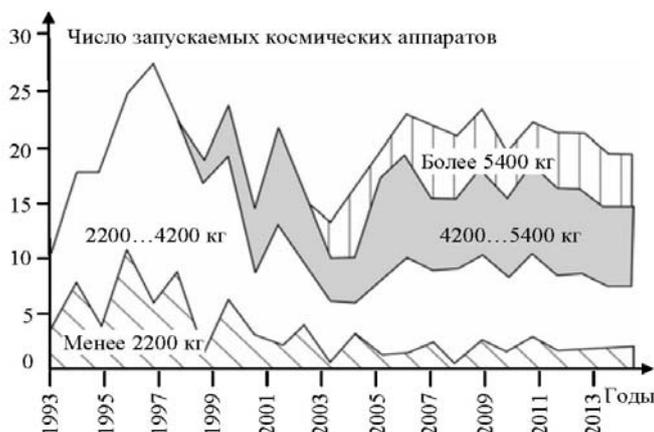
Рис. 1. Тенденция к изменению массы КА, планируемых к запуску на геостационарную орбиту
