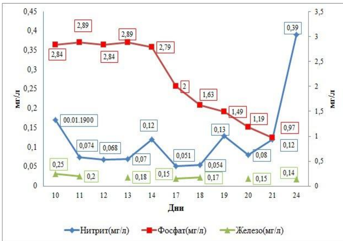
Рисунок. Результаты эксперимента по очистке канализационных сточных вод водорослью Эйхорнией на МУП «Водоканал г. Воткинск»
