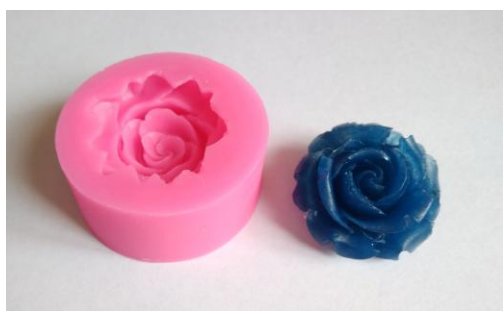
Рис. 5. Силиконовая форма (слева) и полученная отливка (Веретенникова С.А.)
