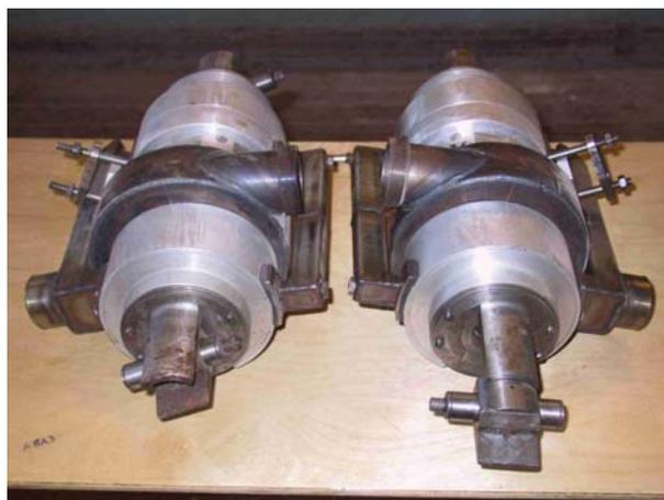
Рис. 5. Пример двух цилиндров дизельного аксиального ДВС модели АДВИ
