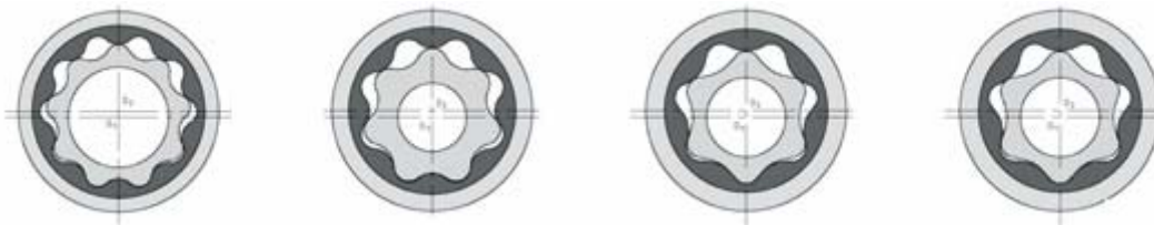
Рис. 2. Торцевой профиль зубьев ротора и статора ВЗД
