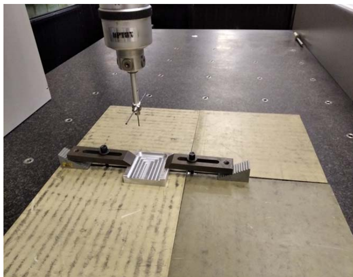
Рис. 2. Измерение геометрических параметров на координатно-измерительной машине
