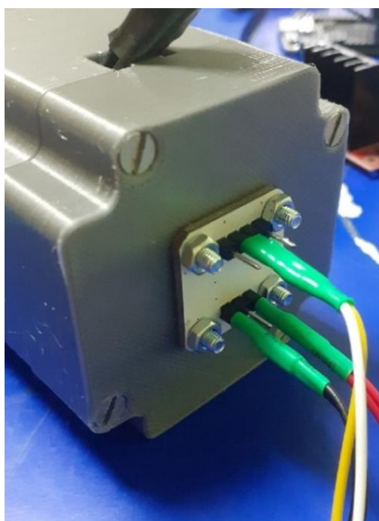
Рис. 9. Крепление модуля энкодера на задней крышке корпуса
