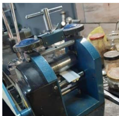
Рис. 3. Процесс прокатки для получения фактуры на заготовке
