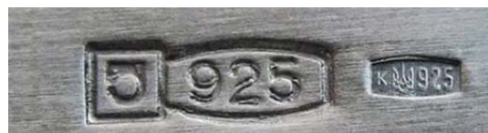
Рис. 2. Пример клейма 925-й пробы серебра
