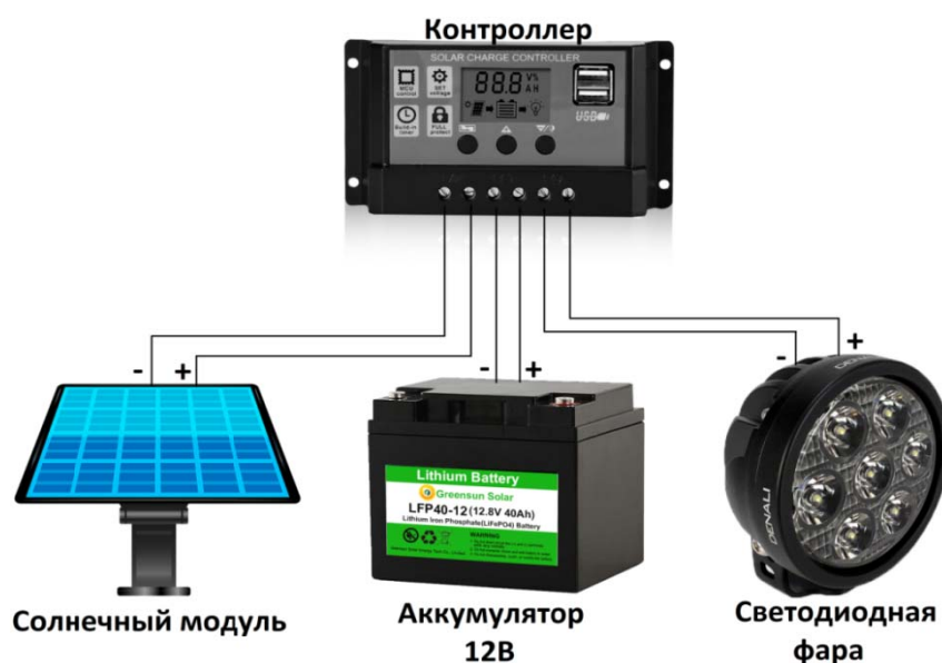
Рис. 2. Схема подключения контроллера к солнечному модулю, аккумулятору и светодиодной фаре (выполнено авторами)
